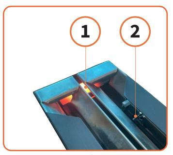
Figure 11.1 | Starter en thermocouple
